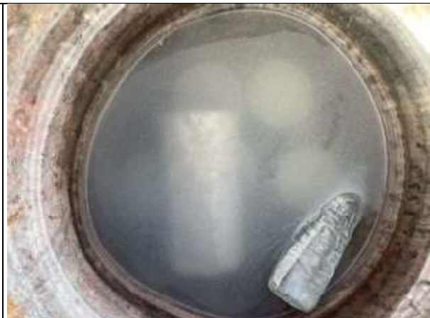
Echantillons béton immergé dans l'eau
