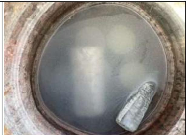
Echantillons béton immergé dans l'eau
